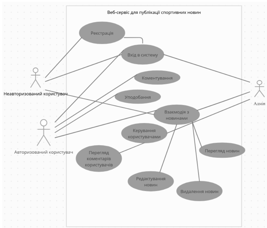
Рисунок 1.8 – Діаграма варіантів використання застосунку «45min»
