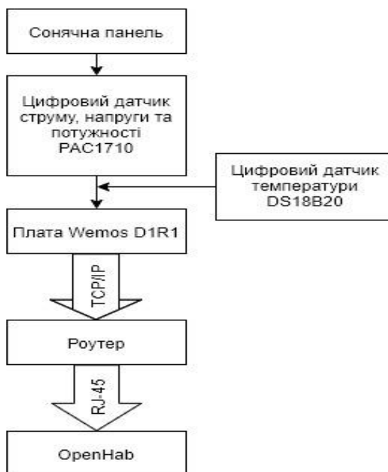
Рисунок 4.1 – Загальна структура схема системи моніторингу сонячних панелей у реальному масштабі часу на основі схеми підключення мікроконтролера WeMos D1 до розумної технології OpenHab
