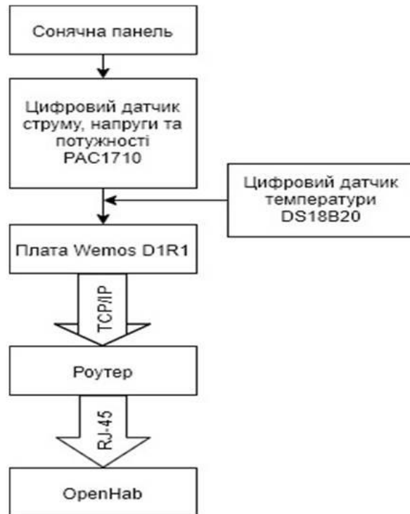
Рисунок 8 – Загальна структура схема системи моніторингу сонячних панелей у реальному масштабі часу
