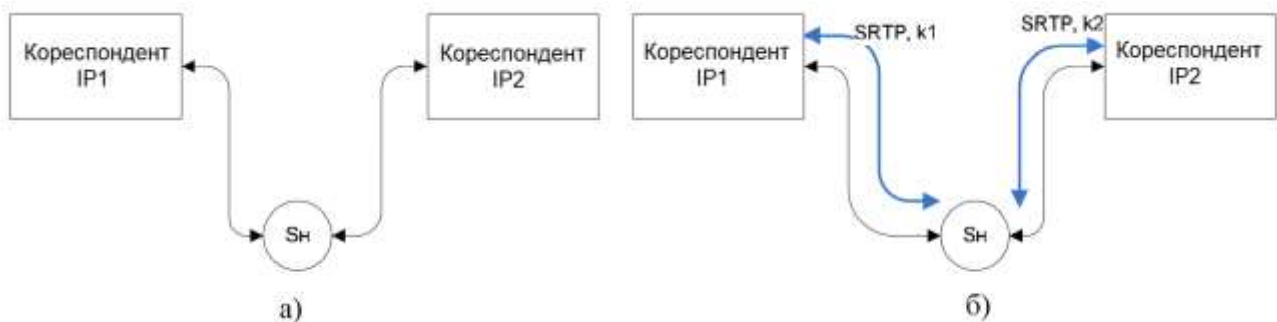
Рисунок 3.4 - Атака з проксінг при виконанні захоплення монітора
