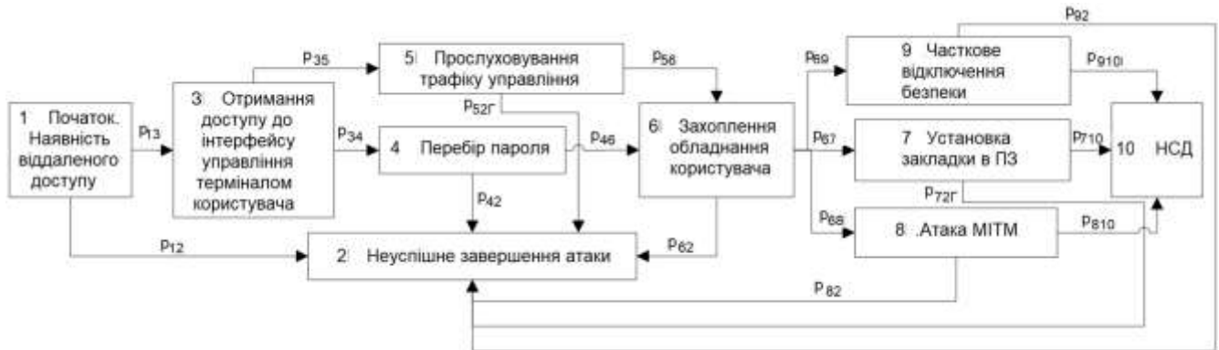
Рисунок 2.5 - Алгоритм дій при виконанні захоплення монітора кореспондента нелегітимним абонентом першого рівня
