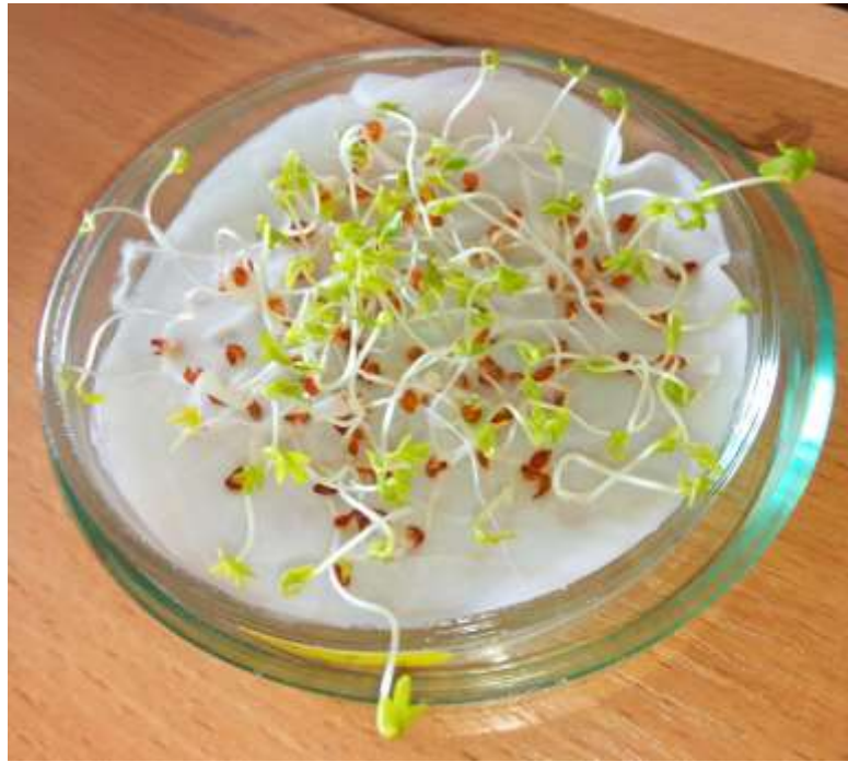
Рисунок 3.9 – Пророщування крес-салату на воді, що піддавалась кавітаційно-магнітній обробці протягом 30-ти хвилин
