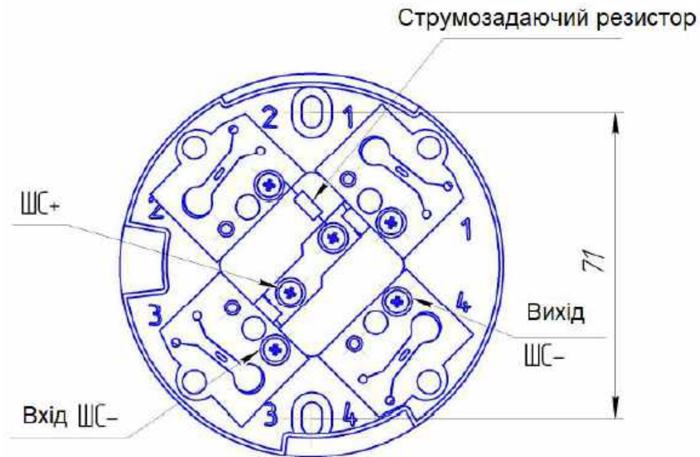
Рисунок 2.25 - Розетка сповіщувача. Загальний вигляд та розташування контактів
