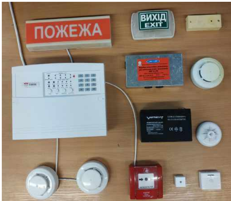
Рисунок 2.27 - Експериментальний стенд системи пожежної безпеки
