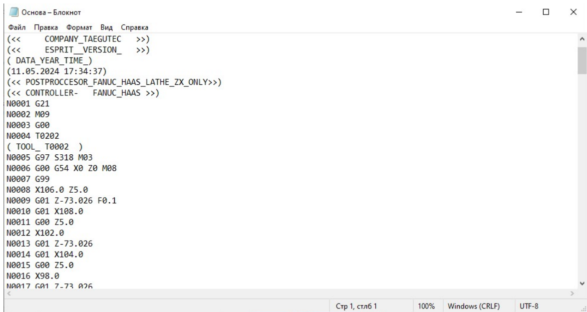
Рисунок 2.16 – Скрін коду програми оброблення на токарному верстаті з ЧПК HAAS ST – 10
