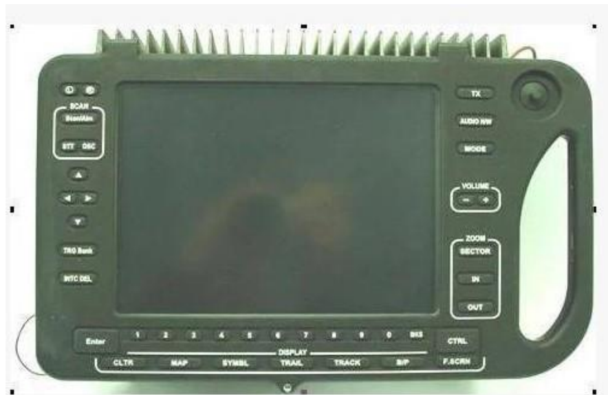
Рисунок 1.3 – Блок індикатора РЛС
