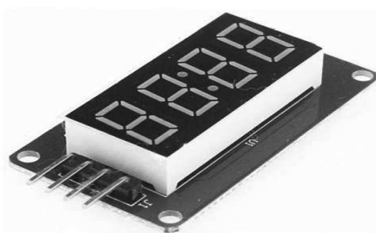
Рисунок 2.2 - Чотирьохрозрядний LED – дисплей на базі мікросхеми TM1637
