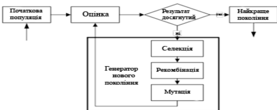
Рисунок 1.3 - Схема роботи GA-NIDS
