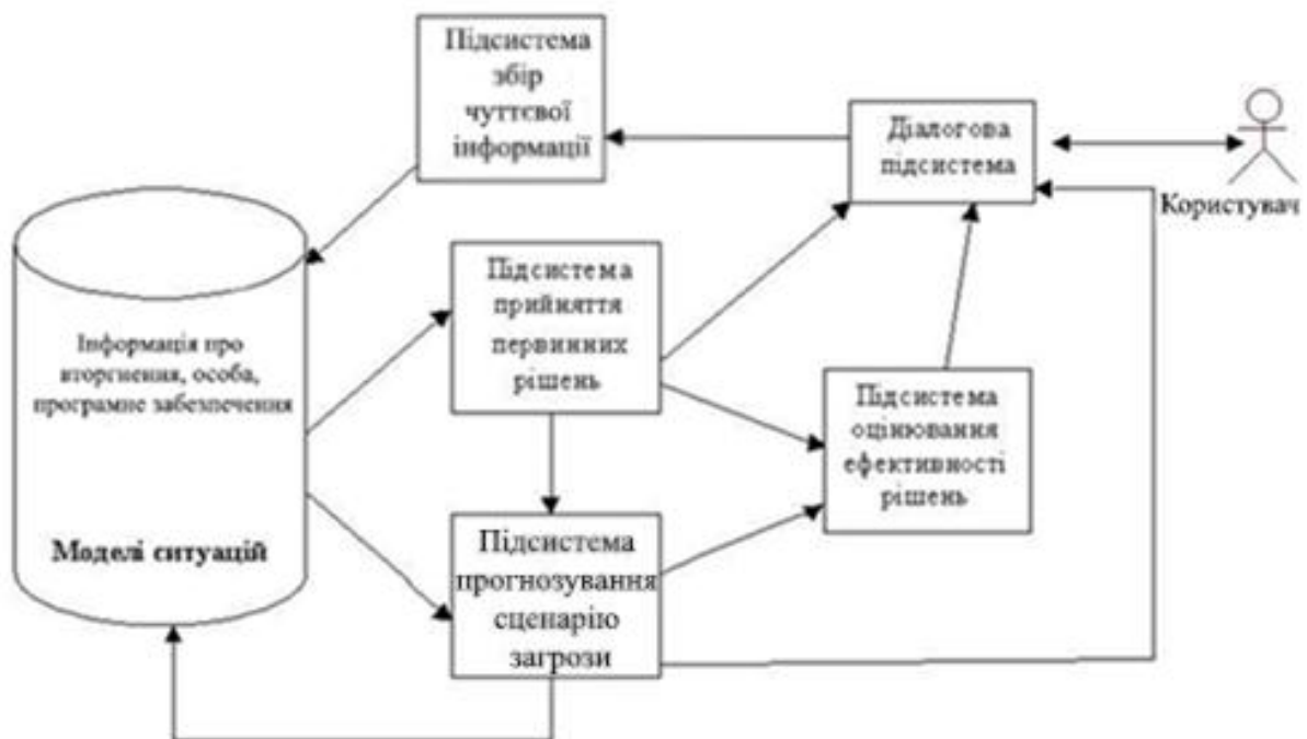
Рисунок 4.1 - Структурна схема виявлення вторгнення в нейронну мережу.
