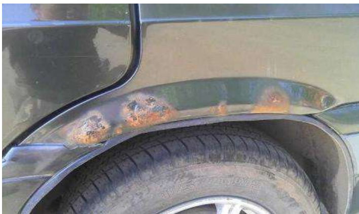
Рис. 1.3 - Деталі кузова автомобілів , що піддаються в процесі експлуатації корозійному руйнуванню з підвищеною інтенсивністю:
