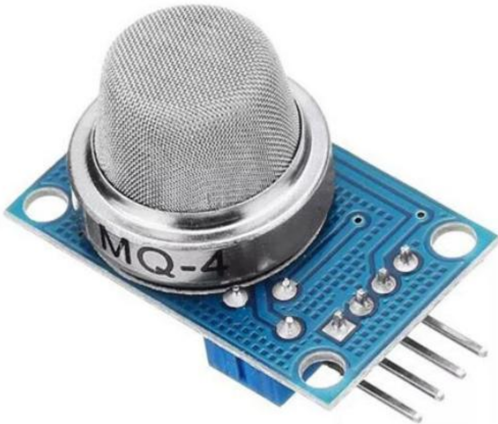
Рисунок 2.2 – Датчик природного газу MQ-4
