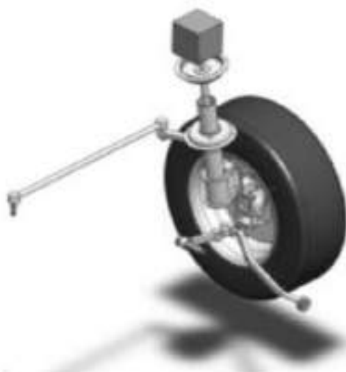
Рисунок 2.1 – Твердо тільна модель підвіски (передня ліва стійка).
