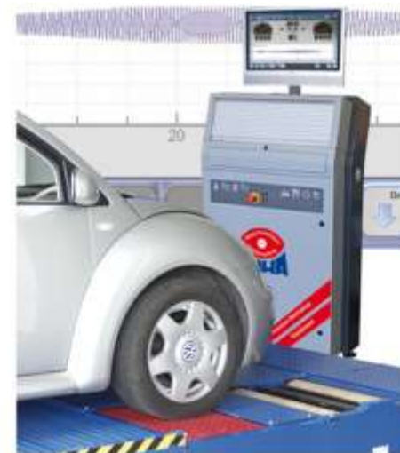
Стенд MSD 3000 для перевірки демпфуючих властивостей підвіски
