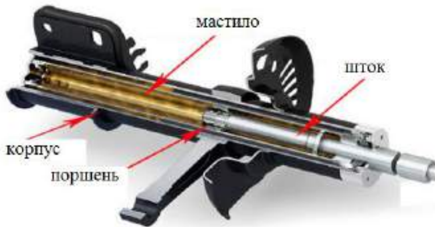
Рисунок 1.4 – Елементарна конструкція амортизатора.
