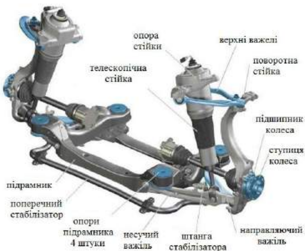
Рисунок 1.3 – Підвіска на напрямних пружинних стійках
