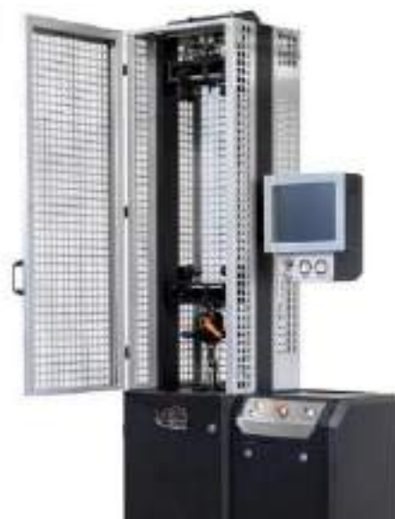
Рисунок 1.11 – Стенд діагностики амортизаторів MS201 [11].
