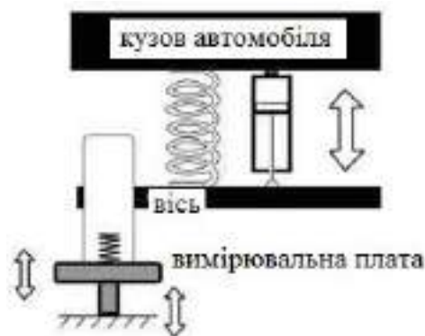
Рисунок 1.8 – Метод діагностування амортизаторів зі зчеплення коліс із дорогою.
