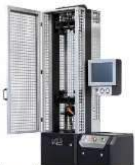
Стенд діагностики амортизаторів MS201
