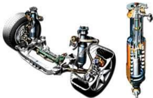
Передня підвіска автомобіля із системою «Active Body Control».
