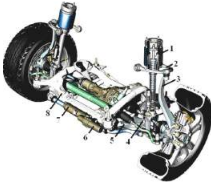
Рисунок 3.11 – Передня вісь підвіски «Airmatic Dual Control»: 1 – пневмостійка; 2 – верхній важіль; 3 – поворотний кулак; 4 – стійка кріплення стабілізатора; 5 – нижній важіль; 6 – енергоакумулятор; 7 – активний стабілізатор поперечної стійкості; 8 - підрамник
