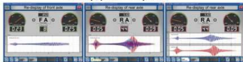
Стенд MSD 3000 для перевірки демпфуючих властивостей підвіски
