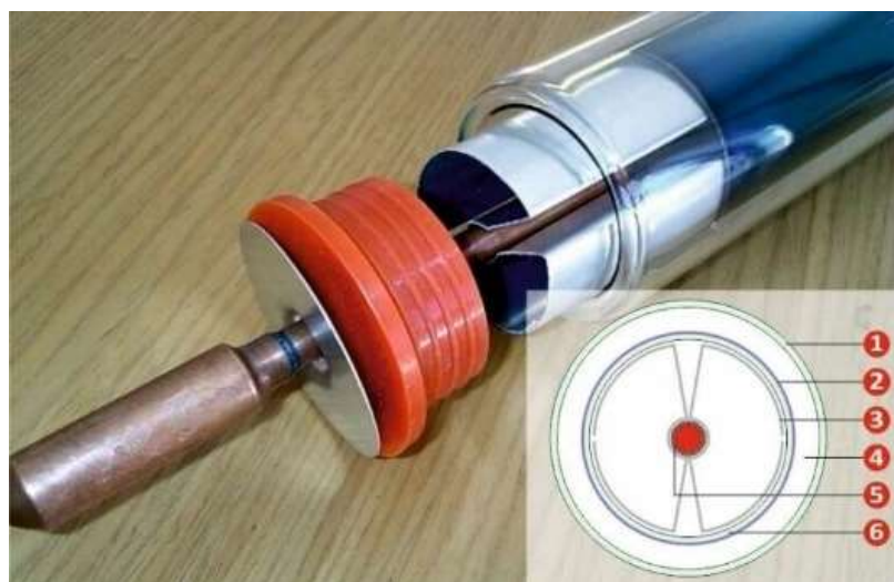
Рисунок 1.14 – Вакуумна коаксіальна трубка в поєднанні з тепловим каналом «Heat-pipe»: 1 – зовнішня скляна колба; 2 – високоселективне поглинаюче покриття; 3 – алюмінієві ребра; 4 – вакуумний прошарок; 5 – тепловий канал з рідиною, яка легко випаровується; 6 – внутрішня скляна колба
