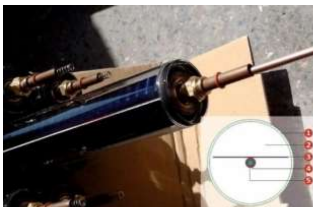
Рисунок 1.16 – Пір’яна трубка з прямоточним тепловим каналом: 1 – скляна колба; 2 – вакуумний прошарок; 3 – мідний абсорбер з високоселективним покриттям; 4 – внутрішній теплової канал з теплоносієм; 5 – зовнішній теплової канал з теплоносієм ( що нагрівається)
