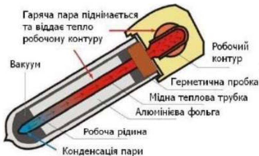
Рисунок 1.10 – Схема роботи теплової трубки у вакуумному сонячному колекторі
