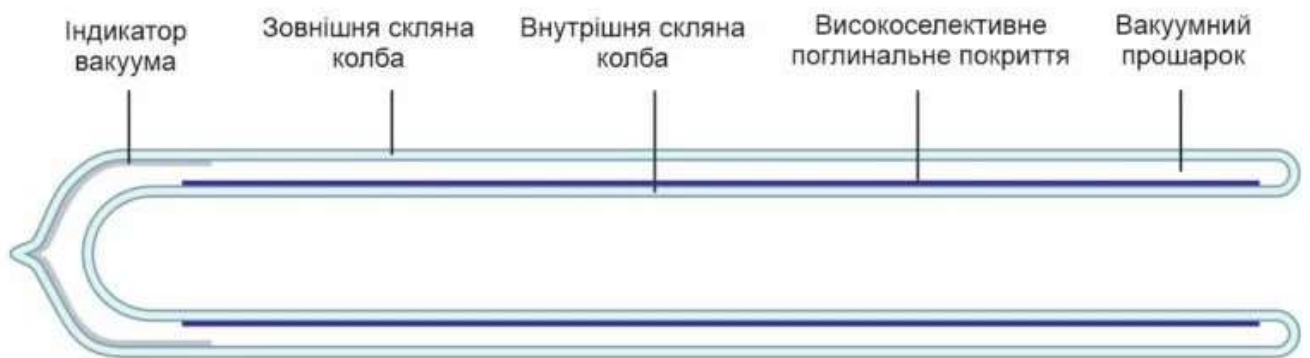
Повздовжній розріз коаксіальної вакуумної трубки
