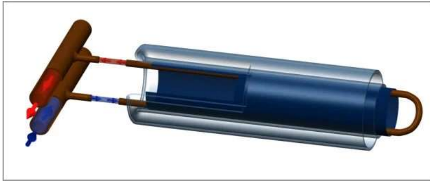
Рисунок 1.12 – Сонячний колектор з прямоточним тепловим каналом та U – подібною трубкою
