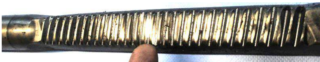
Рисунок 2.4 – Зношення або пошкодження зубців рейки
