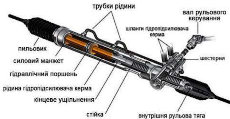
Рисунок 2.1 – Кермова рейка з ГПК [8]
