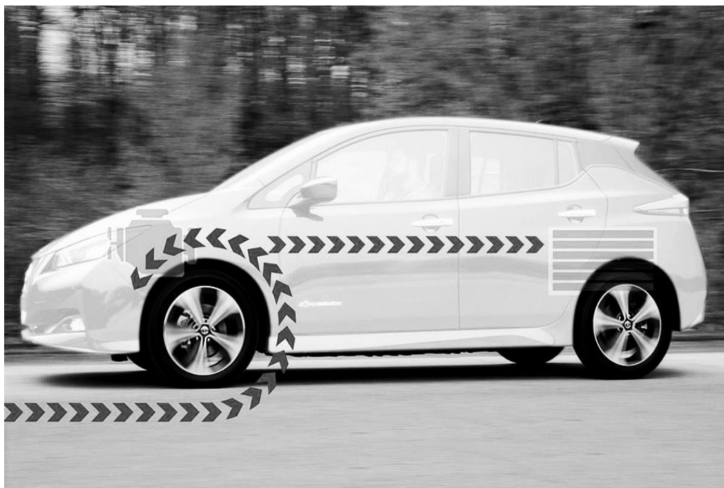
Рисунок 1.15 – Загальна схема рекуперації
