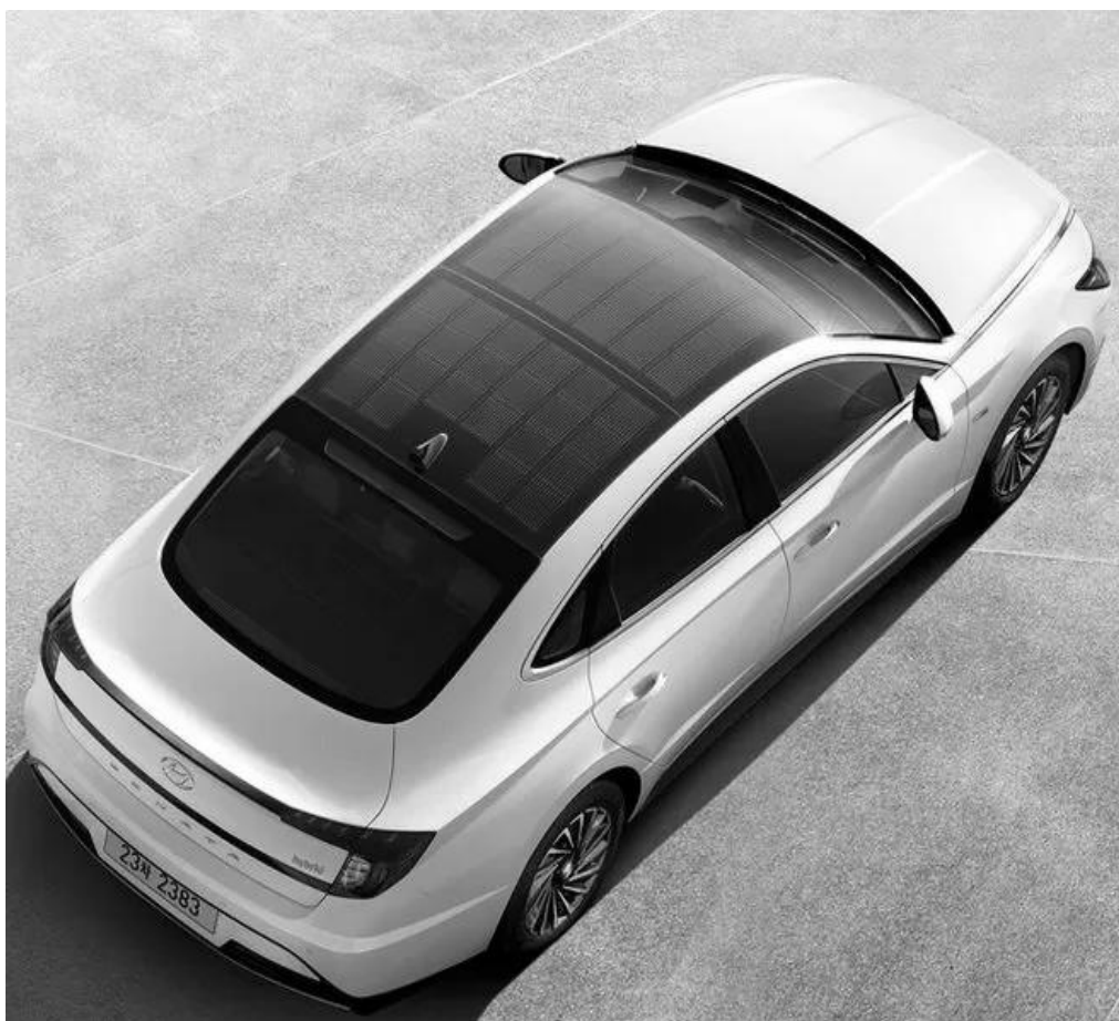
Рисунок 1.13 – Демонстрація використання сонячних панелей на зовнішніх елементах електрокара
