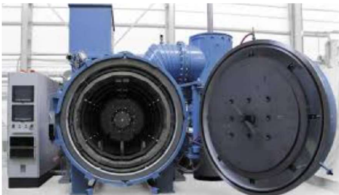
Рисунок 2.8 – Вакуумна термічна піч, яка використовується для цементации при низькому тиску (LPC — Low Pressure Carburizing)
