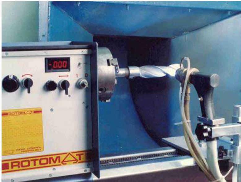
Рис. 2.4. Фінішне плазмове зміцнення сверла
