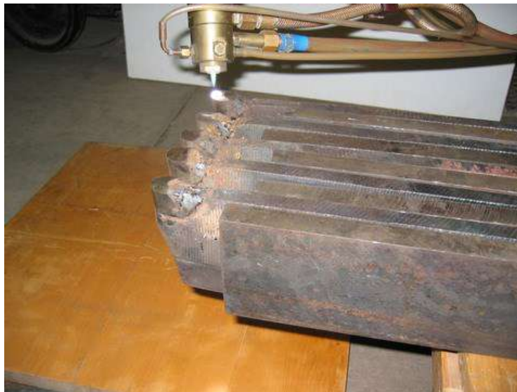
Рис. 2.3. Фінішне плазмове зміцнення різця
