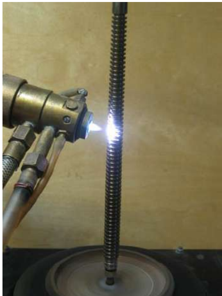
Рис. 2.5. Фінішне плазмове зміцнення
