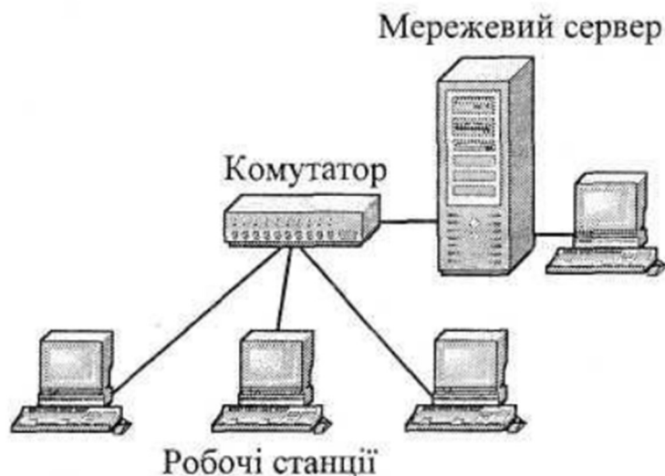
Рисунок 1.5 – Топологія мережі «зірка» з розподіленим керуванням
