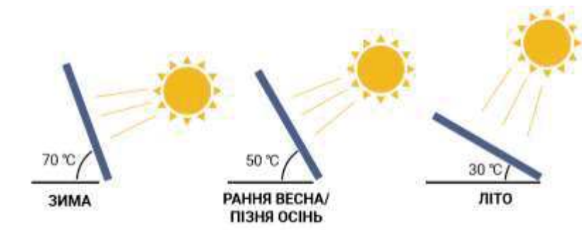
Рисунок 1.6 – Ефективність роботи сонячного елемента, залежно від кута нахилу відносно Землі
