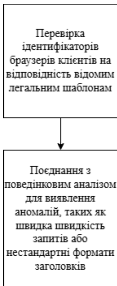
Рисунок 3.12 – Імплементація перевірки параметру User-Agent
