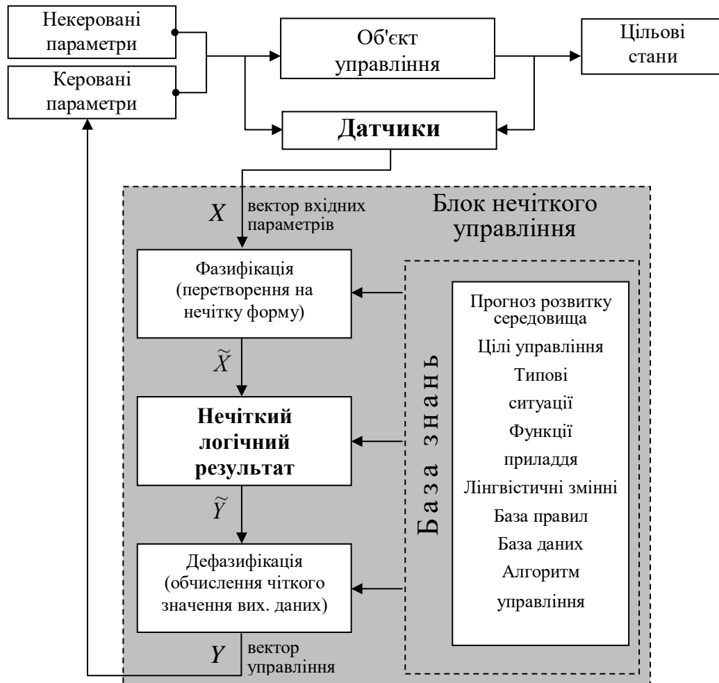
Рис 2.4. – Узагальнена схема апаратних засобів інтелектуальної системи управління з блоком нечіткого управління
