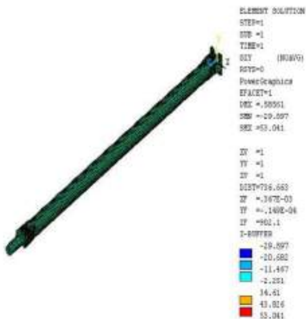
Рисунок 3.15 – Аналіз кручення сталевого валу.
