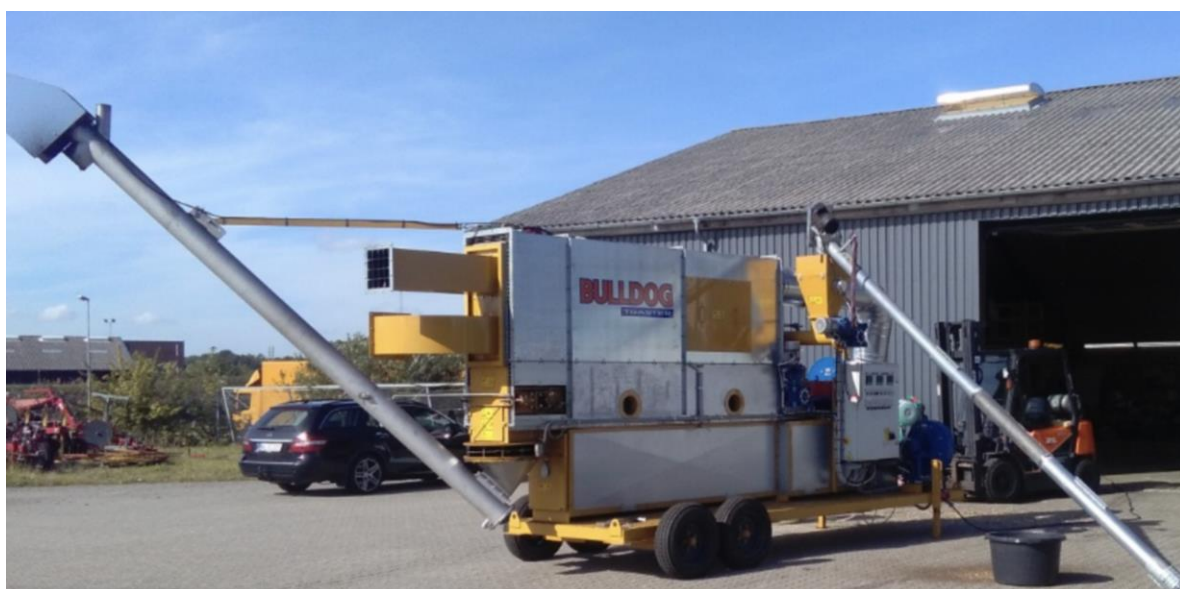
Рисунок 3.4 – Машина для прожарювання сої продуктивністю 2 т/год
