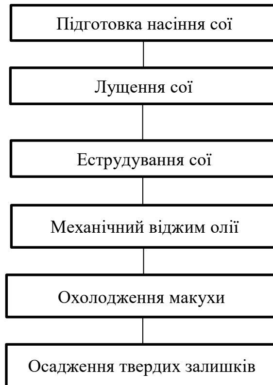
Рисунок 3.6 – Схема механічної переробки сої
