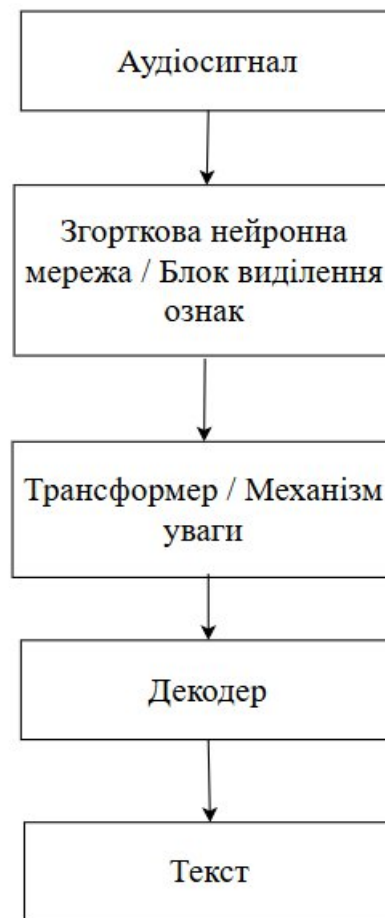
Рисунок 3.4 – Структурна схема підходу на основі end-to-end архітектур для розпізнавання голосу
