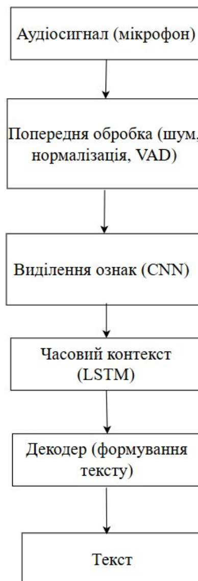
Рисунок 3.5 – Структурна схема запропонованого методу на основі згорткових і рекурентних нейронних мереж
