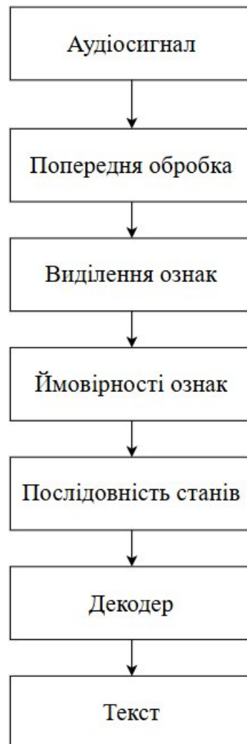
Рисунок 3.1 – Класична система розпізнавання голосу на рівні мовлення
