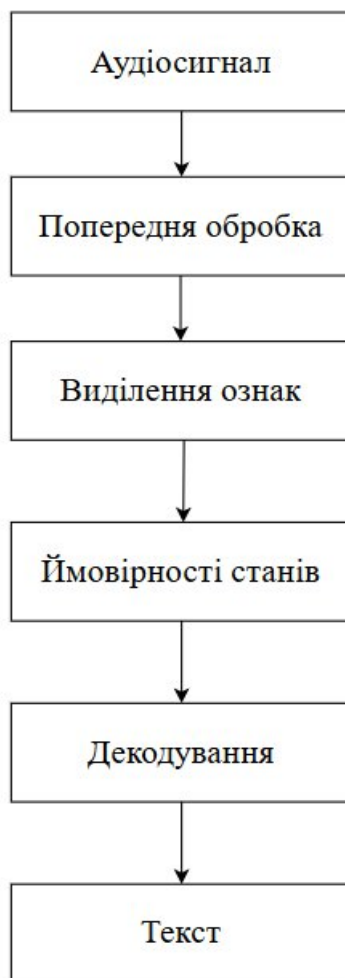
Рисунок 3.2 – Структурна схема нейромережевого підходу розпізнавання голосу на рівні мовлення
