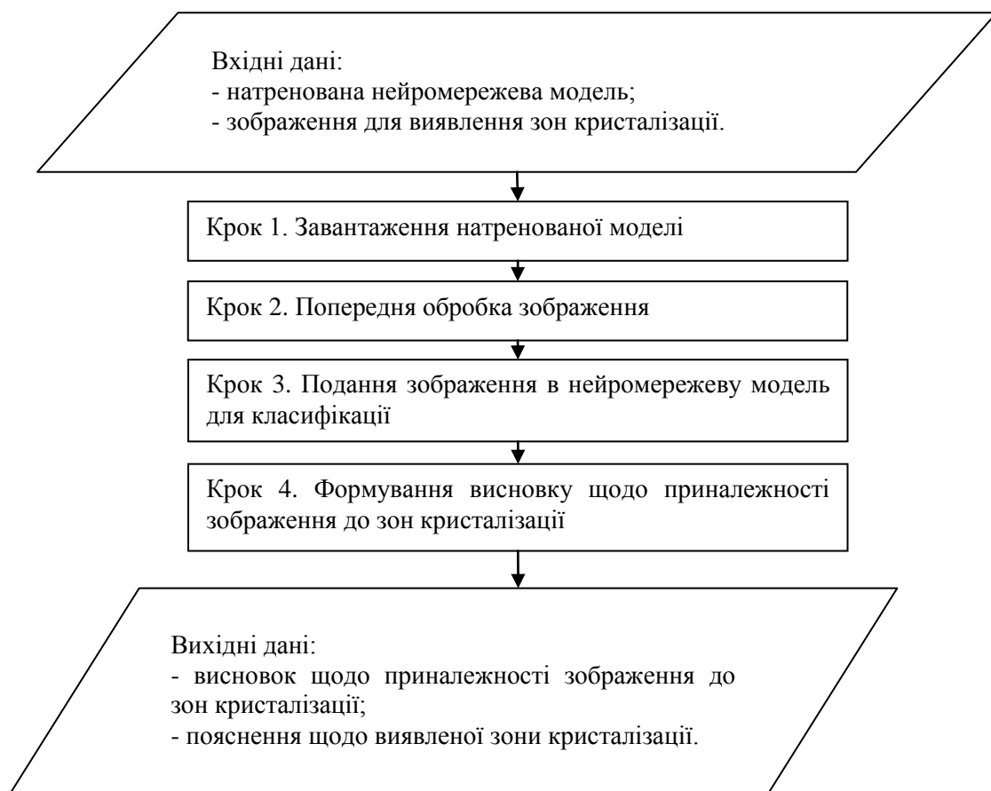
Рисунок 2.1 – Схема та кроки методу виявлення на зображенні зон кристалізації цукру в процесі виробництва
