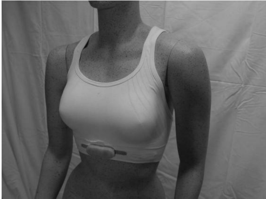
Рисунок 4.6 - Розумний біговий жилет вимірює частоту дихання та пульс і передає дані по бездротовому зв'язку [47]
