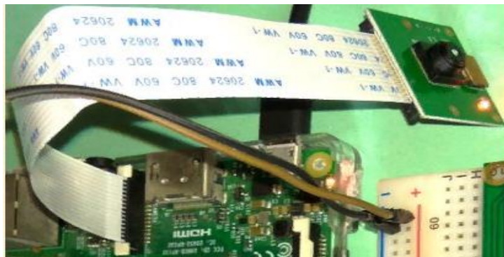
Рисунок 2.4 – Підключення камери до плати Raspberry Pi
