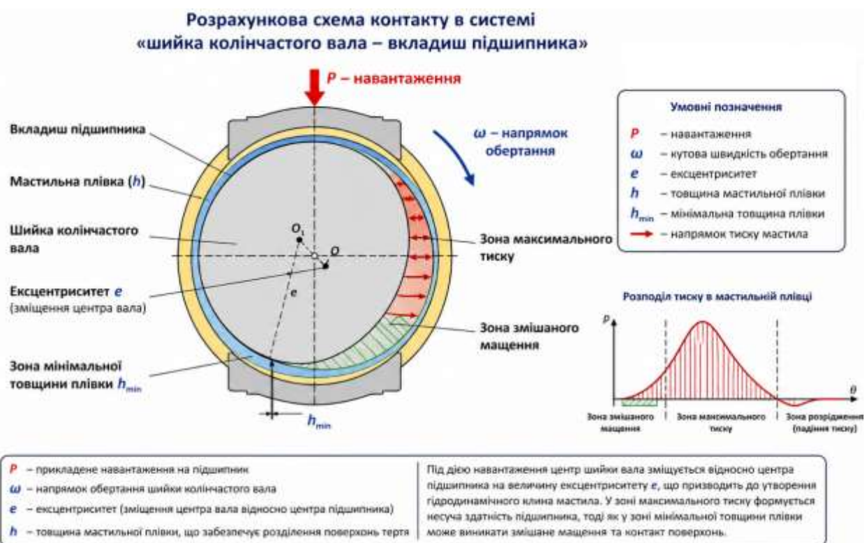
Рис. 8 – Розрахункова схема контакту в системі «шийка колінчастого вала – вкладиш підшипника» з урахуванням навантаження, обертання та формування мастильної плівки
