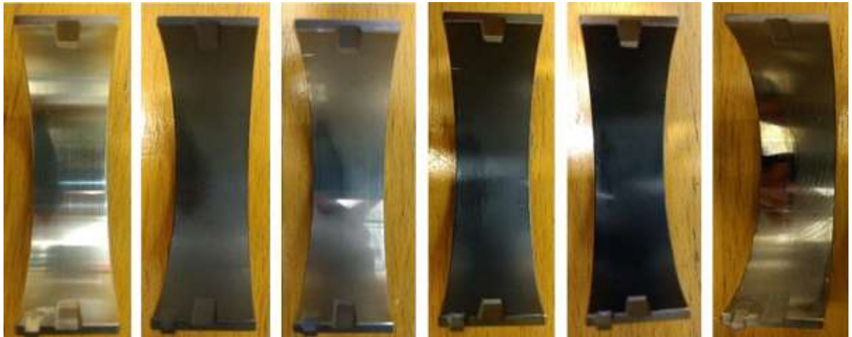
Рис. 22 – Зображення нижніх підшипників після випробування на зношування в умовах перекосу
