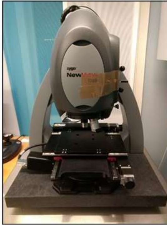
Рис. 17 – (а) 3D-оптичний профілометр Zygo NewView (б) місце вимірювання профілю підшипника
