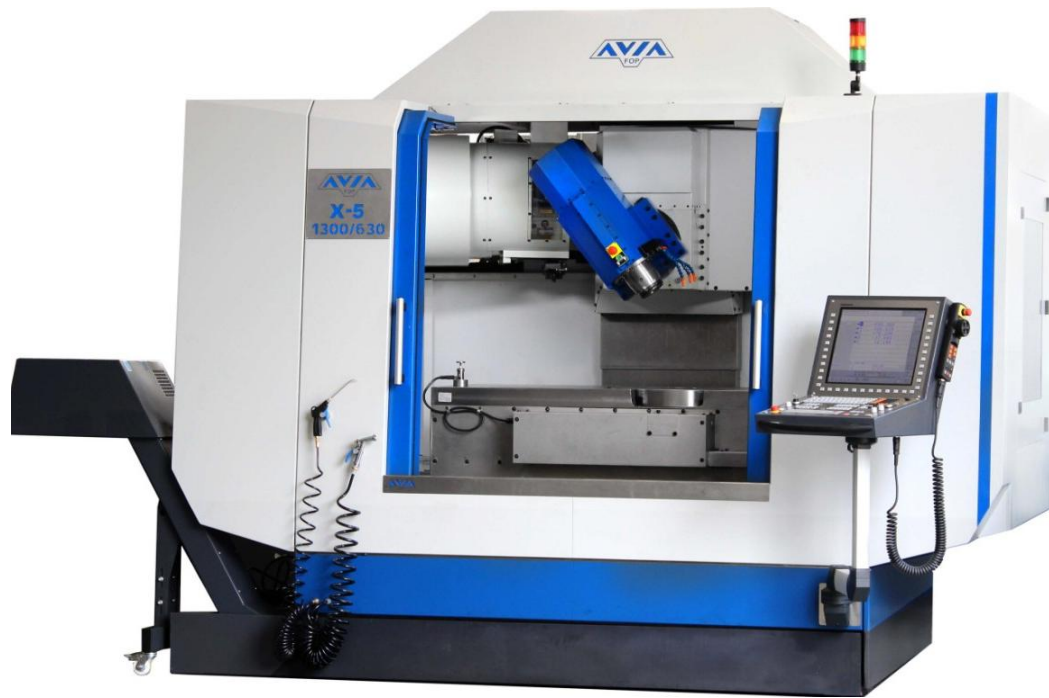
Рисунок 2.2 Універсальний 5-ти осьовий оброблювальний центр AVIA X-5 1300/630
