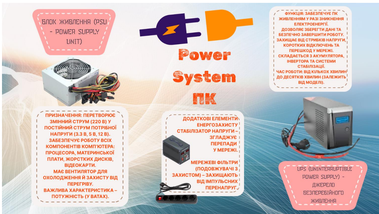
Рисунок Б.6 – Power System ПК
