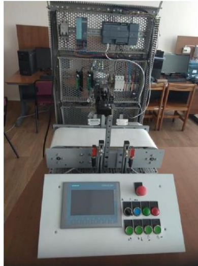
Рис. 2. Стенд для вивчення і дослідження методів керування рухом ТОВ «ТопСітіСервіс»
