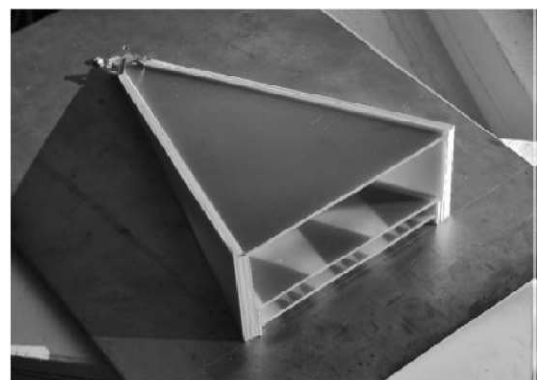
Рисунок 2.4 – Антена на основі вкладених TEM–рупорів
