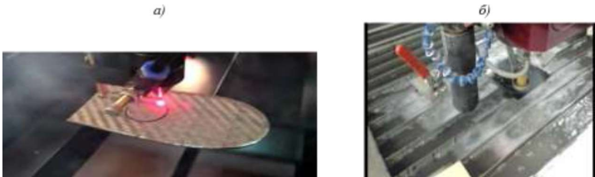
Рисунок 4.1 – Процес виготовлення зразка із склопластику Ø100 мм лазерним способом (а) та перспективний спосіб здійснення обробки – гідрорізання (б)
