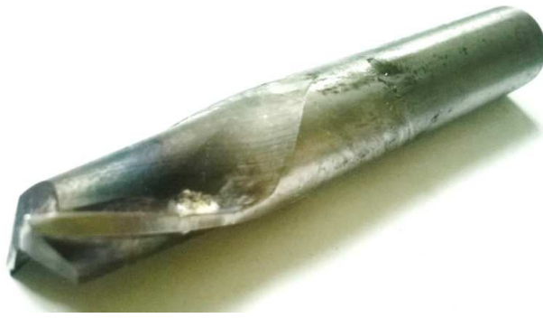
Рисунок 4.11 — Двозуба кінцева фреза (інструментальний матеріал - Р6М5) після роботи при температурі понад 300°С
