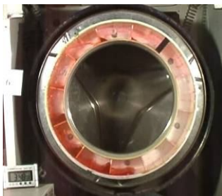
Рис. 3 Фрагмент відеозйомки захвату рідини камерою АБП з перегородками
