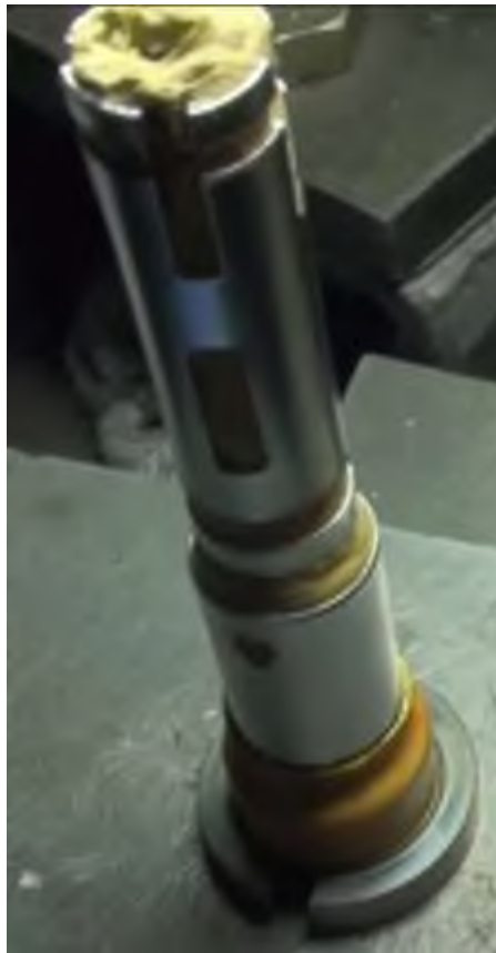
Рис. 3.6. Плунжер після хромування.
