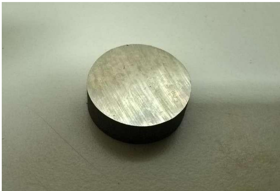
Рисунок 2.5 - Зразок для випробувань на знос \varnothing 22 мм із сплаву 40ХНЮ-ВІ після загартування та старіння
