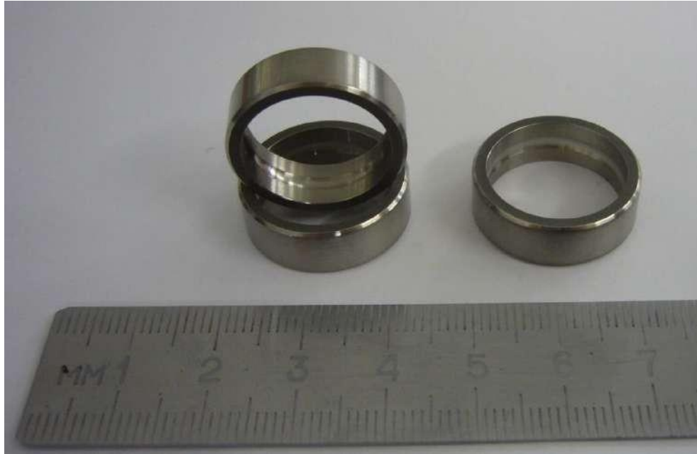
Рисунок 2.1 - Кільця приладових парамагнітних підшипників зі сплаву 40ХНЮ-ВІ, що зміцнюються азотуванням з метою підвищення зносостійкості
