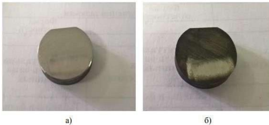
Рисунок 3.11 - Зразки із сплаву 40ХНЮ-ВІ діаметром 30 мм після випробувань на знос:
