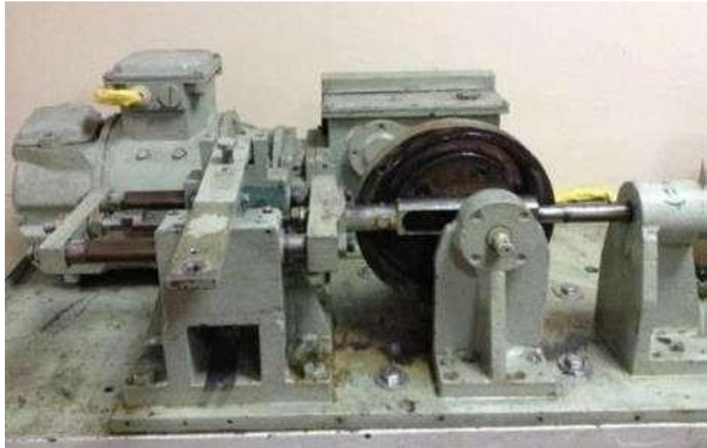
Рисунок 2.8 - Загальний вид машини тертя зворотно-поступальної дії визначення швидкості зношування [88]
