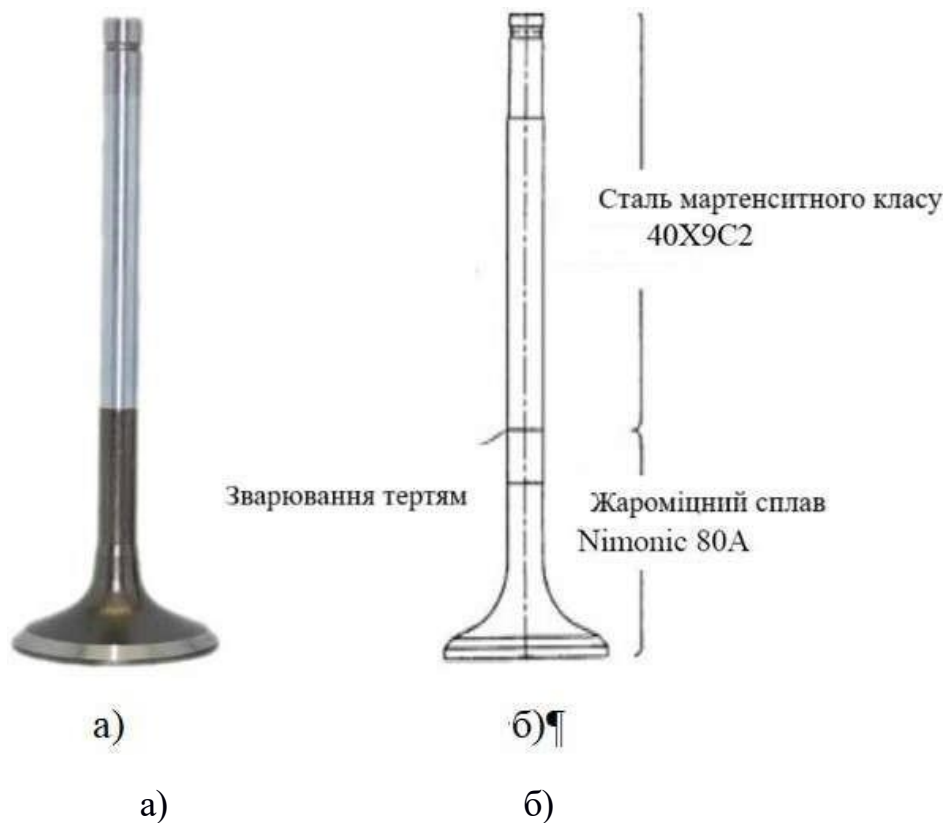
Рисунок 1.1. Конструкція біметалевого клапана дизельного двигуна, (а) - загальний вигляд [11], (б) - креслення [12]
