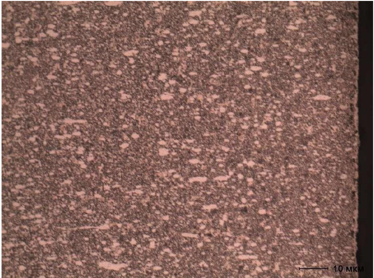
Рисунок 3.3 - Будова азотованого шару сплаву 40XНЮ-ВІ після насичення азотом у плазмі тліючого розряду при температурі 730 °С
