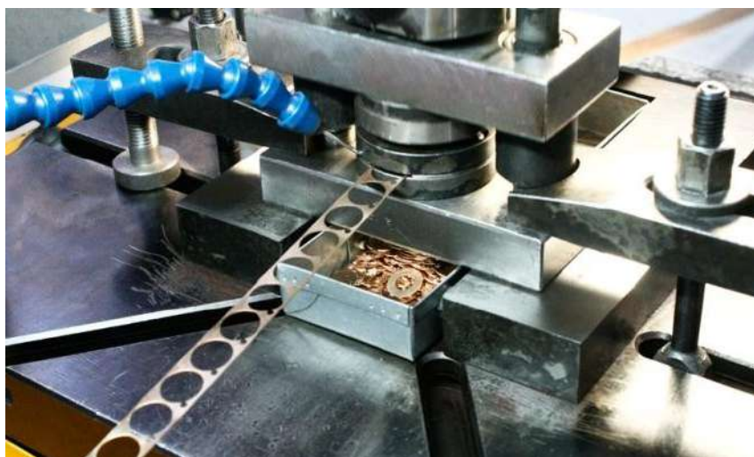
Рисунок 1.4 - Листове штампування деталей
