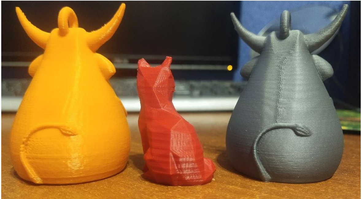
Рисунок 4.4 - Зображення зміщення шарів по вісі Z
