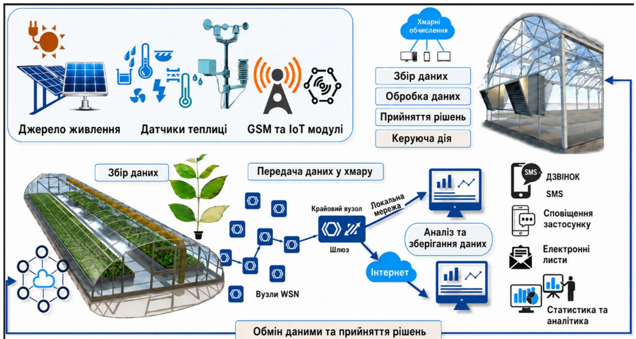
Рисунок 1.4 – Діаграма взаємодії “сенсори → події/моделі → керуючі дії” у тепличному моніторингу (WSN + подієве керування) [7]
