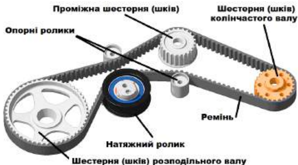
Рисунок 1.4 – Ремінний привід ГРМ
