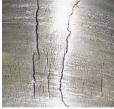
Рисунок 1.11 – Приклад тріщини розподільного валу
