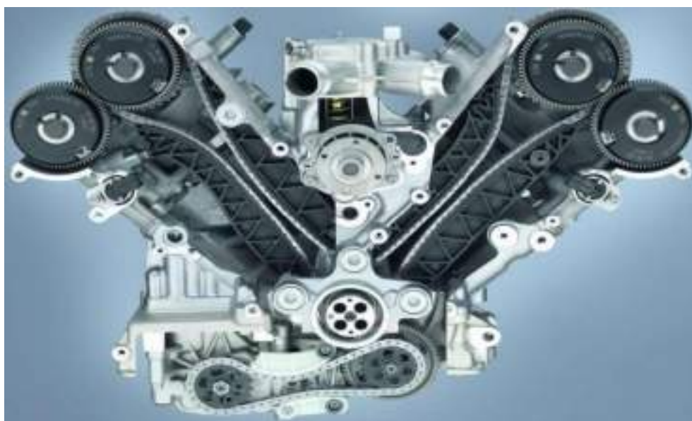
Рисунок 1.6 – Комбінований привід ГРМ
