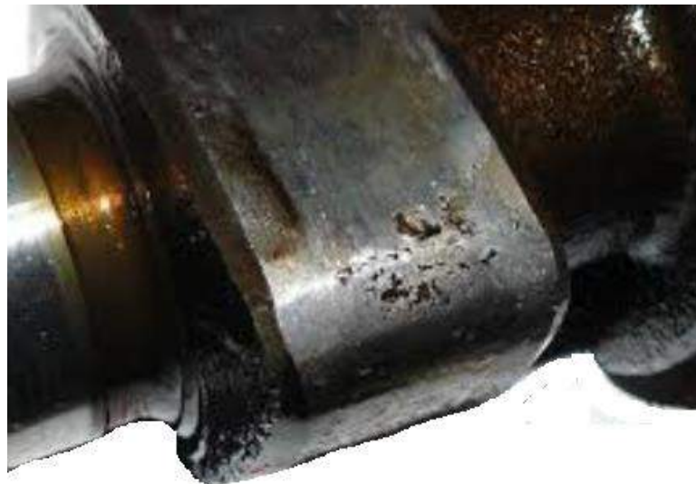
Рисунок 1.13 – Виразки, задирки, раковини на кулачку валу
