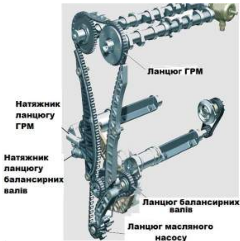
Рисунок 1.3 – Ланцюговий привід ГРМ
