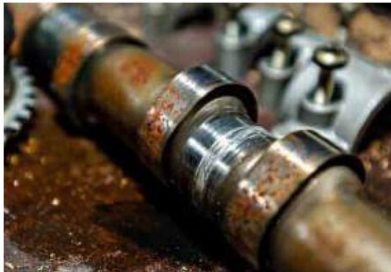
Рисунок 1.9 – Зношування та пошкодження шийок валу
