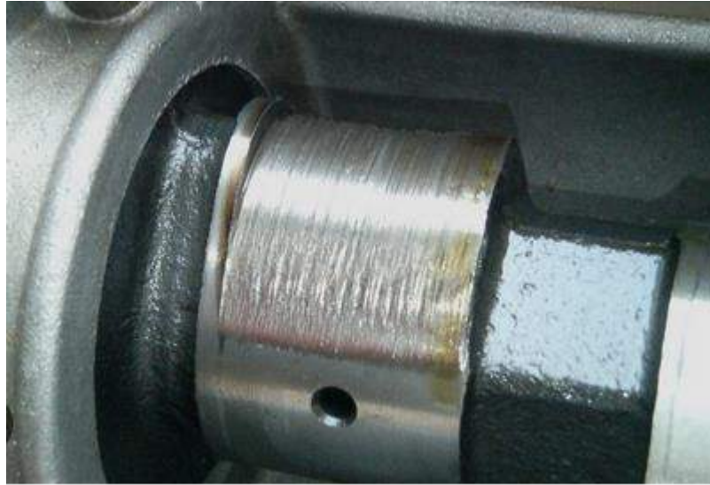
Рисунок 1.10 – Приклад зношування кулачків розподільного валу
