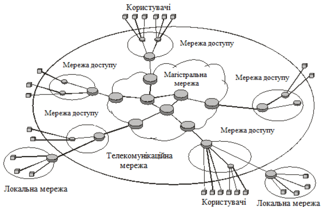
Рисунок 1.2. – Структурна схема телекомунікаційної мережі
