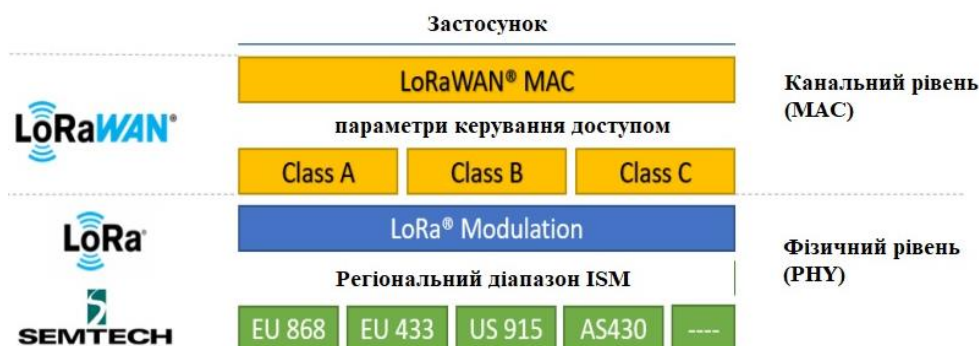
Рисунок 1.4 – Технологічний стек LoRaWAN
