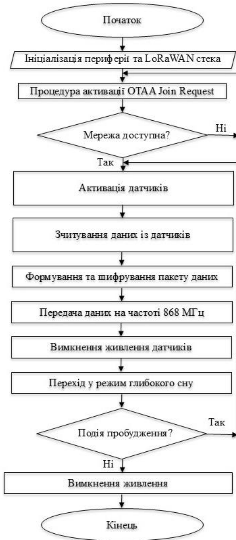
Рисунок 3.1 – Блок схема алгоритму роботи автоматизованої системи збору даних у сільському господарстві
