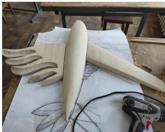
Рисунок 2.3.9 – З'єднання крил до фюзеляжу літака
