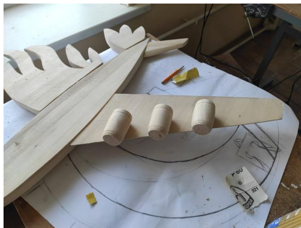
Рисунок 2.3.10 – З'єднання авіаційних двигунів до правого крила
