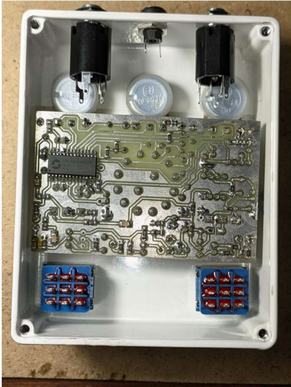
Рисунок 3.28 - Примірка компонентів перед фінальним монтажем в корпус
