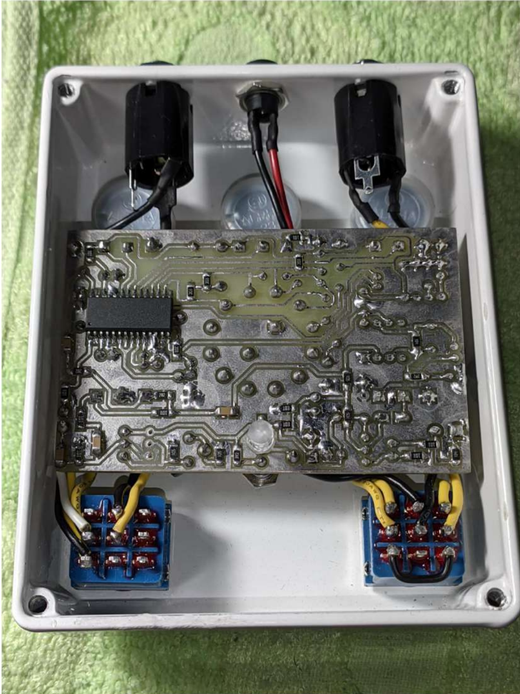
Рисунок 3.29 - Завершений монтаж плати
