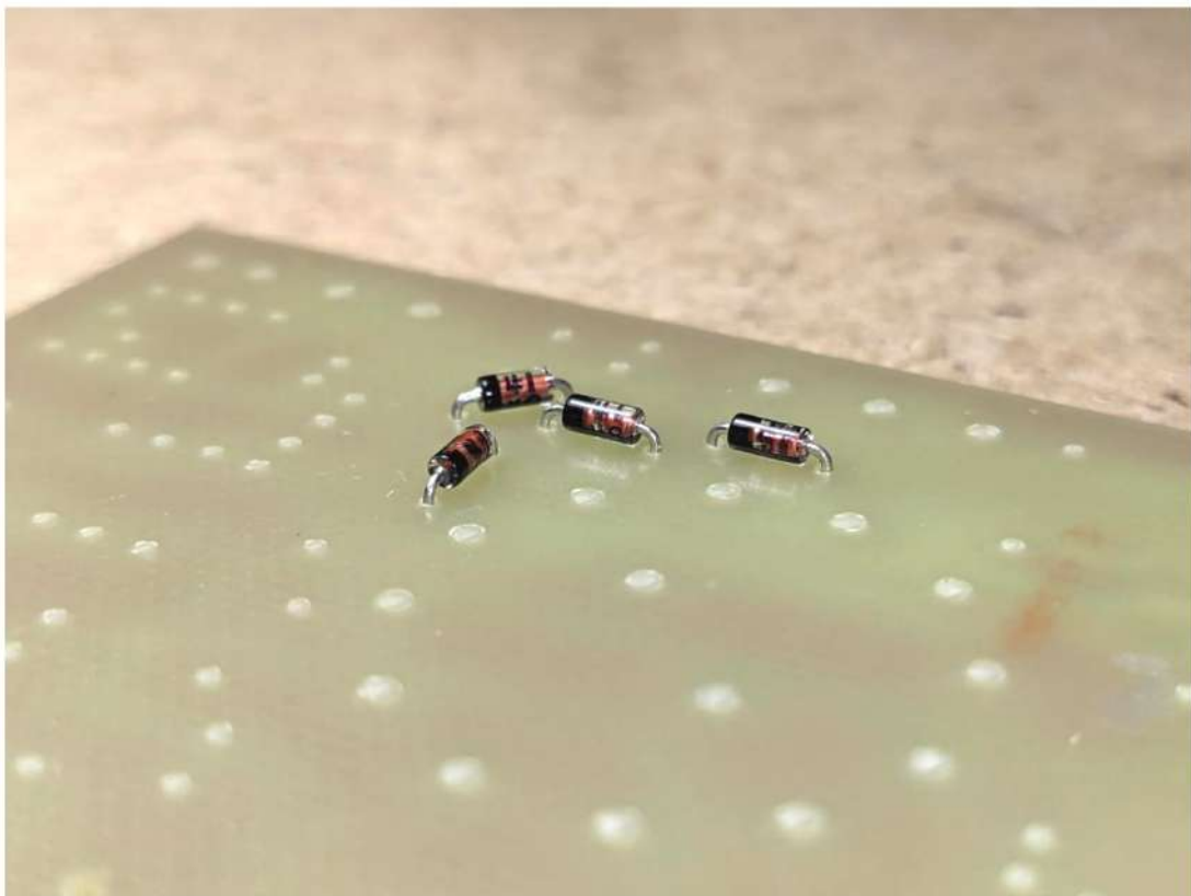
Рисунок 3.23 - Монтаж діодів, вигляд зі сторони деталей
