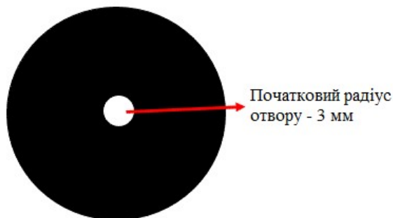
Рисунок 4.41 – Операція свердлування (вид зверху)
