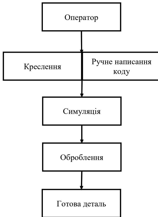
Рисунок 2.4 – Підхід до оброблення деталі на HAAS VM3 з аналізом коду оператором
