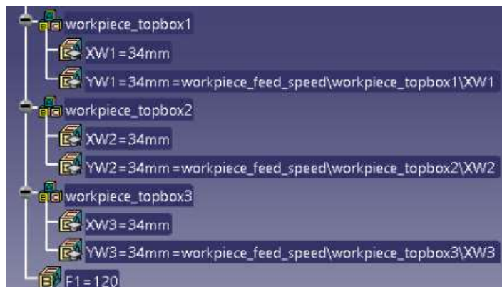
Рисунок 4.57 – Параметри, створені для видалення залишків матеріалу в процесі обробки
