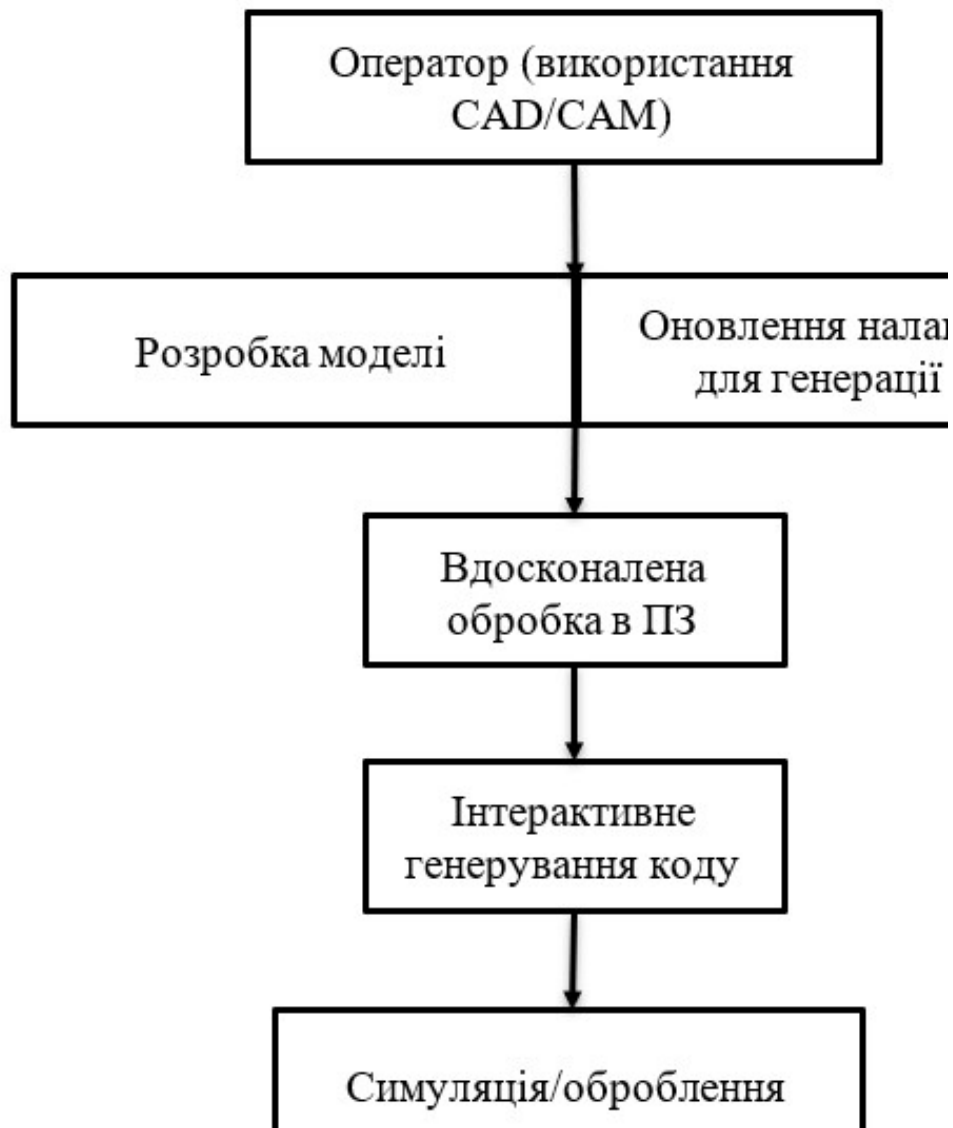
Рисунок 2.5 - Підхід до оброблення деталі на HAAS VM3 з автоматичною генерацією коду
