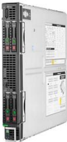
Рисунок 2.9 - Сервер HP ProLiant BL660c Gen9
