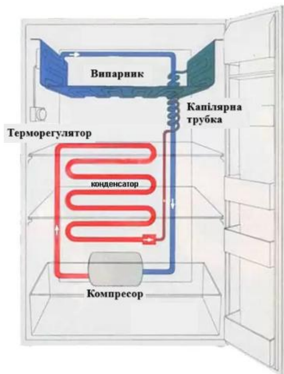
Рисунок 1.4 – Конструкція побутового холодильника
