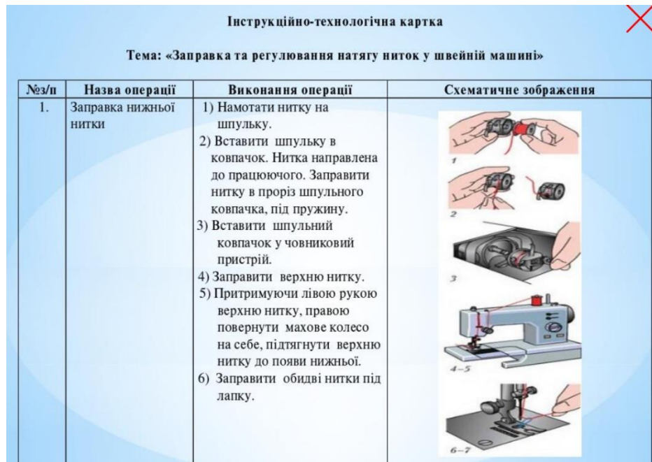
Рисунок 1.8 – Фрагмент інструкційно-технологічної картки з теми «Заправка та регулювання натягу ниток у швейній машині». Заправка нижньої нитки
