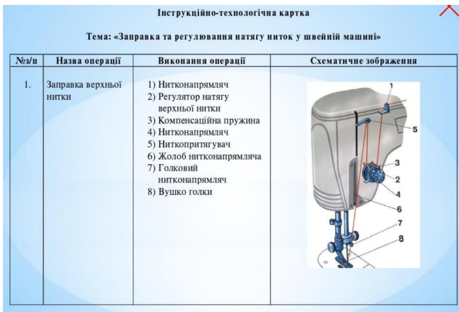
Рисунок 1.9 – Фрагмент інструкційно-технологічної картки з теми «Заправка та регулювання натягу ниток у швейній машині». Заправка верхньої нитки
