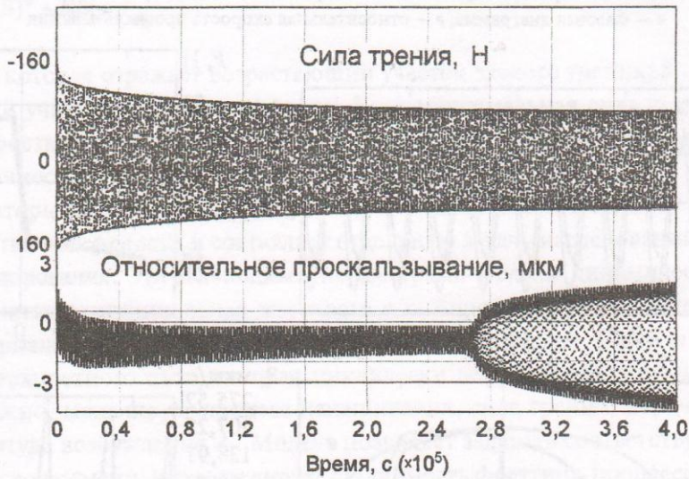
Рис. 11. Долговременная эволюция силы трения и переход к глобальному проскальзыванию
