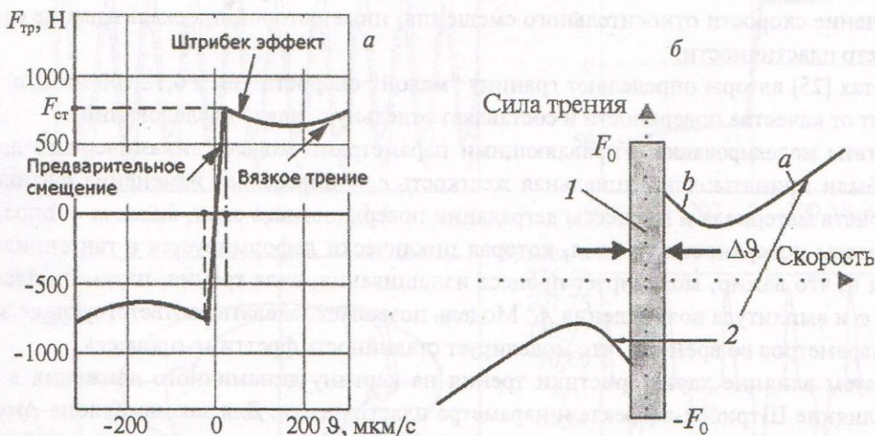
Рис. 6. Характеристики силы трения с учетом упругой тангенциальной деформации, предварительного смещения, Штрибек-эффекта и вязкости трения (а). Графическое пояснение параметров характеристик трения (б): 1 — область сцепления; 2 — область скольжения
