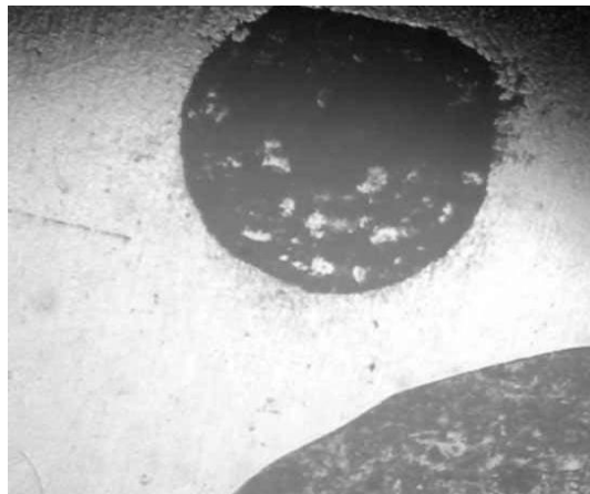
Рисунок 16 – Дефекти в обсязі отриманого шару
