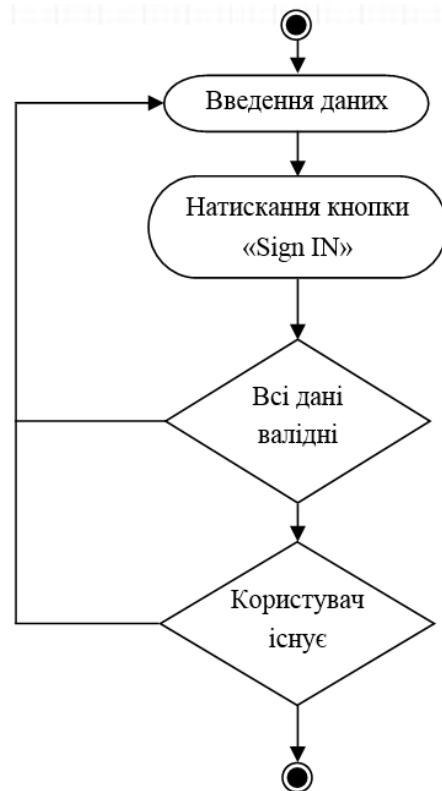
Рис. 2. Діаграма станів входу користувача
